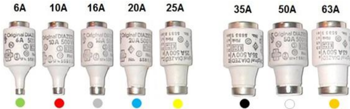
Figuur 4: Nominale stroomsterkte waarvoor de smeltzekering is ontworpen, af te lezen aan de kleur van de verklikker. Beeld: Rob Kalmeijer
